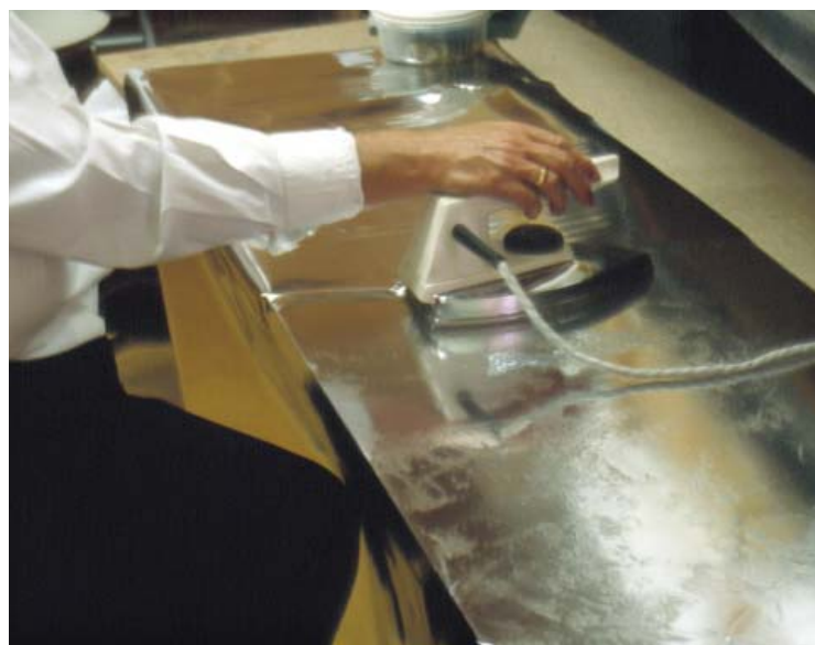
Figura 5: Proceso de termosellado de balda de madera con plástico metalizado de barrera. (Fot.: Archivo MNAD)
