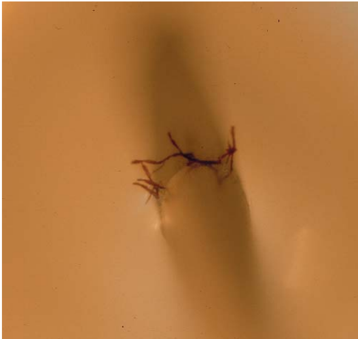
6. Test de temperatura de contracción: la misma fibra después de la contracción (Foto: Museo del Traje. C.I.P.E.)
