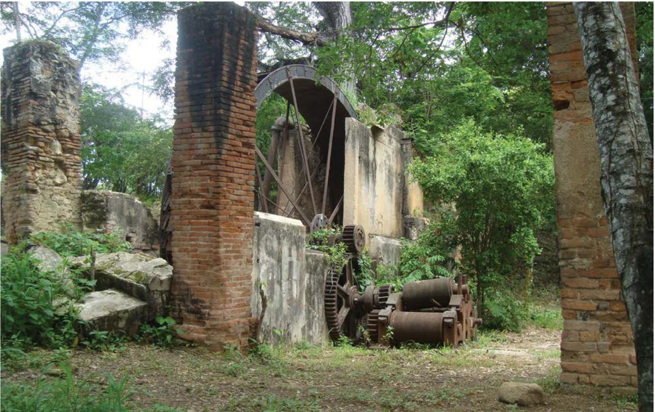
Figura 6. Rueda hidráulica y molino de mazas o cilindros horizontales, fabricados en metal, Terraza 3. Fotografía: L. Molina, 2015.
